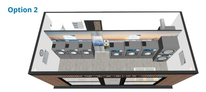
3 laveuses WPR-8, capacité 8 kg 1 laveuse WED-14, capacité 14 kg 2 laveuses WED-18, capacité 18 kg 1 séchoir double STD-16, capacité 2 x 16 kg
