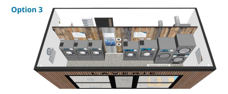
3 laveuses WPR-8, capacité 8 kg 1 laveuse WED-14, capacité 14 kg 2 laveuses WED-18, capacité 18 kg 1 séchoir simple DD-16, capacité 16 kg 1 séchoir double STD-16, capacité 2 x 16 kg
