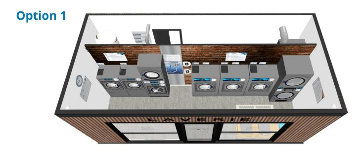
2 laveuses WPR-8, câpacité 8 kg 1 colonne WPR-8 + DPR-8, laveuse + séchoir capacité 8 kg 3 laveuses WED-18, capacité 18 kg 1 séchoir double STD-16, capacité 2 x 16 kg
