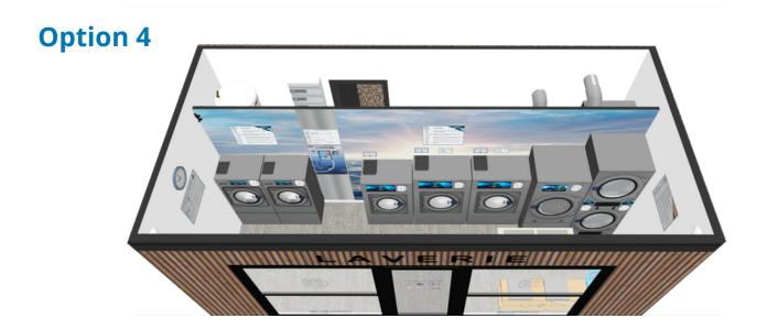
2 laveuses WPR-8, capacité 8 kg 1 laveuse WED-14, capacité 14 kg 2 laveuses WED-18, capacité 18 kg 1 séchoir simple DD-16, capacité 16 kg 1 séchoir double STD-16, capacité 2 x 16 kg
